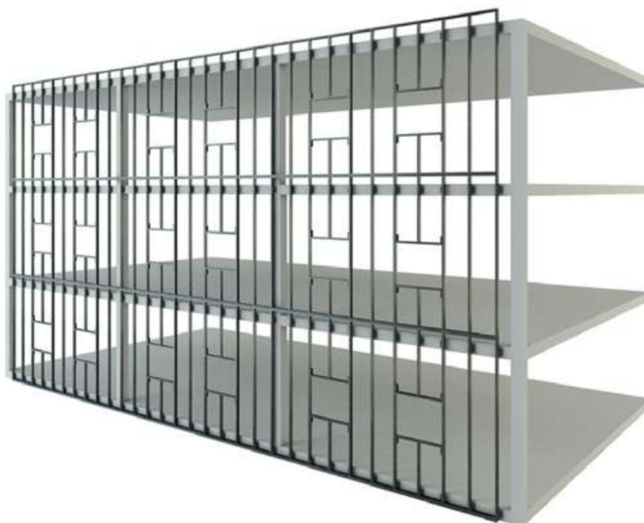
Figura 4.6 - Esquema de execução de steel frame por método contínuo.
